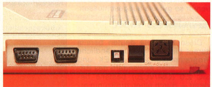
Der C128 von der Seite: Zwischen Joystick-Anschlüssen und Netzschalter liegt eine Reset-Taste
